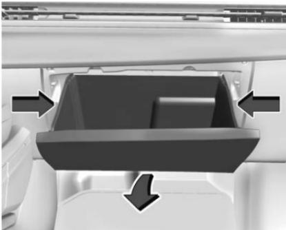
2. Presione los lados del depósito de la guantera hacia adentro para pasar los topes y gire hacia abajo para bajar el depósito.
