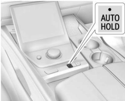
Cuando se activa el Sostenimiento automático del vehículo y se frena el vehículo, la función evita que el vehículo se mueva durante la transición de la liberación del pedal del freno al pedal del acelerador. Los frenos se liberan cuando se aplica el pedal del acelerador. Los frenos también se pueden liberar bajo otras condiciones. No confíe en Sostenimiento automático de vehículo para sostener el vehículo.
