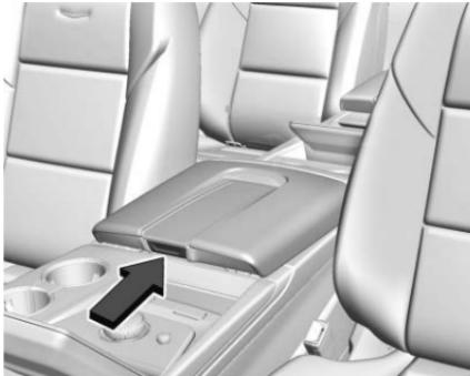
Presione el botón y levante para abrir. Hay un conector auxiliar, puertos USB, un tomacorriente para accesorios, un compartimiento de carga, y un soporte de dispositivo en el interior.
