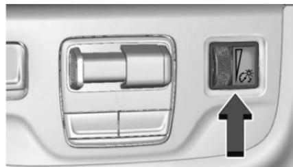
Gire esta rueda giratoria para ajustar el brillo de todos los controles iluminados. La rueda giratoria está en el tablero de instrumentos a la izquierda del volante.
