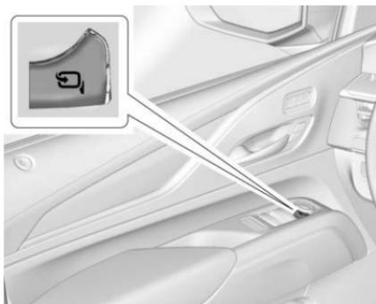
Si está equipado, presione para plegar eléctricamente los espejos. Presione nuevamente para desplegar.
