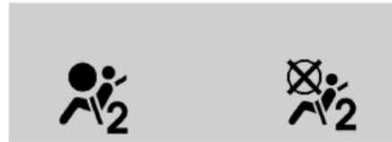
Los símbolos del indicador de estado de la bolsa de aire del pasajero se iluminarán por varios segundos como una verificación del sistema. Entonces, después de varios segundos más, el indicador de estado se iluminará para indicarle el estado de la bolsa de aire delantera del pasajero externo delantero y de la bolsa de aire de las rodillas. Vea *Indicador de estado de bolsa de aire del pasajero* ⇨ 105.
