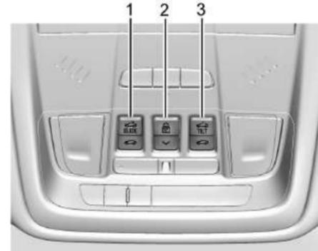
1. Interruptor de quemacocos (SLIDE - Deslizar)
