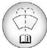
Abra el tapón que tiene el símbolo del lavaparabrisas. Agregue líquido para lavaparabrisas hasta llenar el tanque. Vea en *Vista general del compartimiento del motor* ⇨ 259 la ubicación del depósito.
