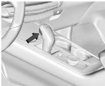
Este vehículo está equipado con transmisión controlada electrónicamente. El botón de liberación de bloqueo de cambios está diseñado para evitar que se cambie
