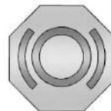
El depósito del cilindro maestro de frenos se llena con líquido de frenos DOT 4 aprobado por GM, como se indica en el tapón del depósito. Vea en *Vista general del compartimiento del motor* ⇨ 259 la ubicación del depósito.
