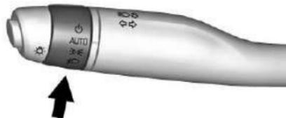
El control de las lámparas exteriores está en la palanca de señal direccional.
