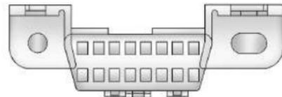
El DLC está debajo del tablero de instrumentos del lado izquierdo del volante. Conectar dispositivos que no se utilicen para realizar una Inspección de emisiones/Prueba de mantenimiento o para dar servicio al vehículo puede afectar la operación del vehículo. Vea *Equipo eléctrico incorporado* ⇨ 254. Visite a su distribuidor si necesita asistencia.
