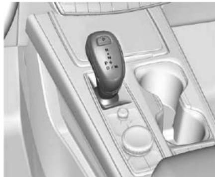
El patrón de cambios se muestra en la parte superior de la palanca de cambios. La posición de velocidad seleccionada se iluminará en rojo en la palanca de cambios, mientras que todas las demás se proyectarán en blanco. Si el cambio no es inmediato, como en condiciones muy frías, el indicador en la palanca de cambios puede parpadear hasta que esté completamente accionado.
