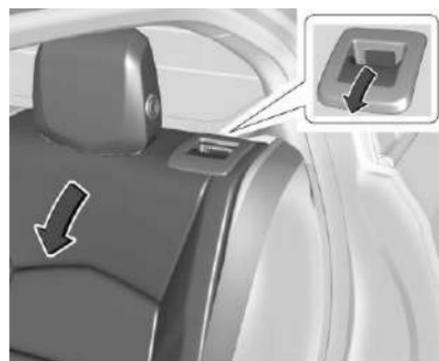
3. Jale la palanca en la parte superior del respaldo para desbloquearlo y plegar el respaldo hacia adelante.
