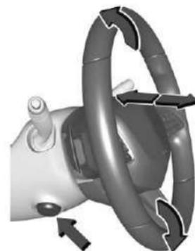
Presione el control para mover la inclinación y el ajuste telescópico del volante hacia arriba y hacia abajo o hacia adelante y hacia atrás.
