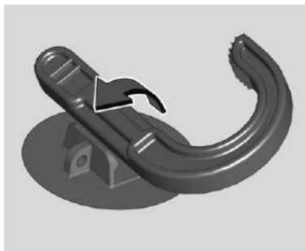
1. Inserte un lado del gancho del piso de carga en el soporte.
