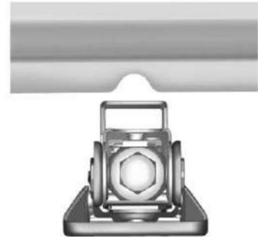
Ubique la muesca en el reborde de soldadura de lámina. Coloque el centro de la cabeza de elevación del gato en el centro de la muesca de la lámina.
