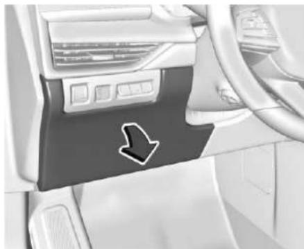
El bloque de fusibles del tablero de instrumentos está en el lado del conductor del tablero de instrumentos, entre el volante y la
