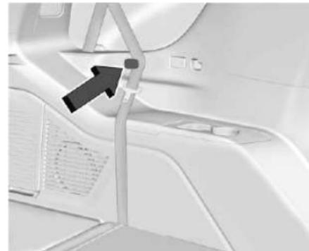
1. Asegúrese que el cinturón de seguridad esté en el sujetador de almacenamiento del cinturón.
