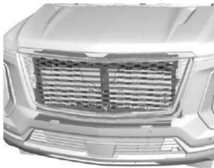
Este vehículo puede tener un sistema de obturador que cierra automáticamente la abertura de enfriamiento frontal. El vehículo puede contar con un sistema de obturador diseñado para ayudar a mejorar la economía de combustible. Mantenga el sistema de obturador libre de desechos, nieve, y hielo. Si la luz revisar el motor está activada, verifique si el sistema de obturador está libre de desechos, nieve o hielo.
