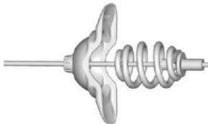
Incline el dispositivo de retención y jálelo así como el cable y el resorte a través del centro de la rueda.
