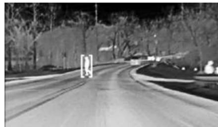
Con el sistema de Frenado delantero de peatones activado, la Visión nocturna proporciona una alerta roja de Pantalla transparente (HUD) cuando el sistema detecta que el vehículo se está acercando muy rápido
