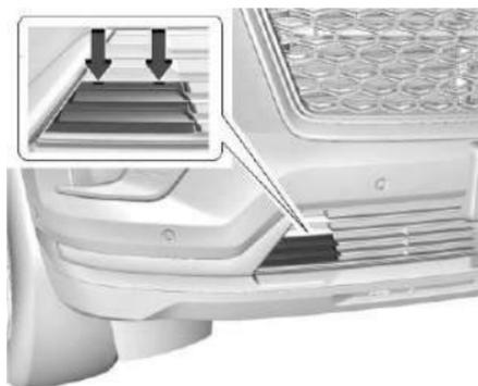
3. Retire la cubierta del conector del calentador del motor haciendo palanca suavemente en la muesca pequeña con una herramienta de punta plana.
