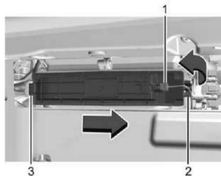
4. Desconecte el cable eléctrico (1) en el lado derecho de la puerta de filtro, desconecte la puerta y jale hacia afuera (2), y después desconecte desde el lado izquierdo (3) para retirar la puerta. Retire el filtro anterior.
