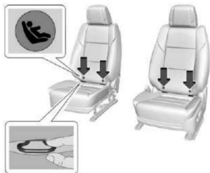
Los anclajes inferiores de asiento ejecutivo están en el pliegue entre el respaldo y el cojín del asiento. Empuje la moldura del respaldo hacia arriba en el pliegue para tener acceso al anclaje inferior.
