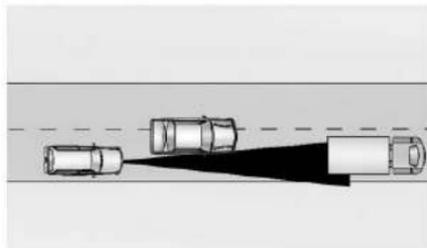
El ACC no detectará a un vehículo por delante hasta que esté completamente en el carril. Debe estar preparado para aplicar los frenos manualmente si es necesario.
