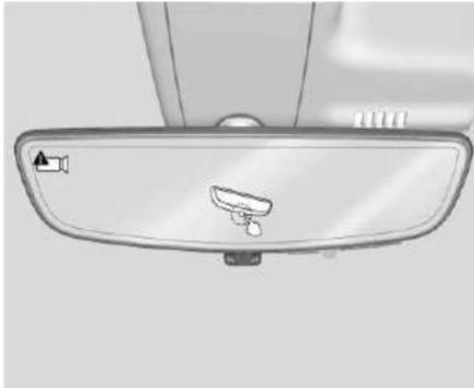
Consulte a su distribuidor para servicio si se muestra una pantalla azul y
