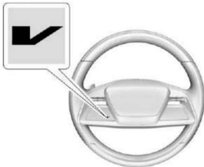
Si está equipado, para activar el modo V, presione el botón de modo V en el volante.
