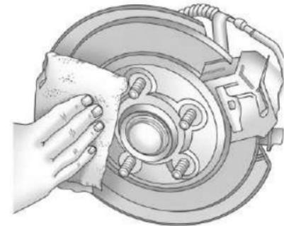
8. Elimine todo el óxido y la suciedad de los pernos de la rueda y las superficies de montaje y la rueda de refacción.
