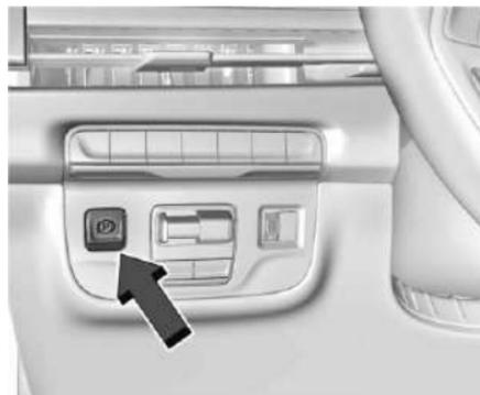
El Freno de estacionamiento eléctrico (EPB) puede aplicarse cuando el vehículo apagado. Si no hay suficiente energía eléctrica, el EPB no se puede aplicar ni liberar. Para evitar que se agote la batería, evite ciclos repetidos innecesarios del EPB.
