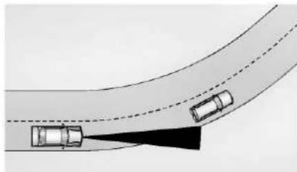
Al seguir a un vehículo y entrar en una curva, el ACC puede no detectar un vehículo que va adelante y acelerar a la velocidad establecida. Cuando esto sucede, la luz indicadora del vehículo que va delante no se muestra.
