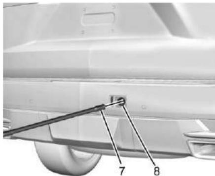
4. Inserte el extremo abierto de la extensión (7) a través del orificio que se encuentra en la defensa trasera (8) (orificio de acceso a la flecha del elevador).
