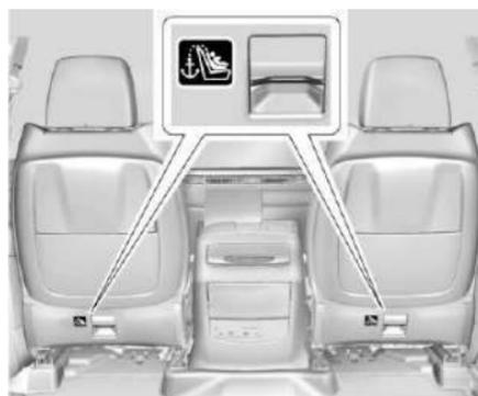
Los anclajes de atadura superior de asiento ejecutivo están en la estructura inferior del respaldo del asiento detrás de una ranura de tela. Deslice el asiento hacia adelante para tener acceso al anclaje. Asegúrese de utilizar el anclaje ubicado directamente detrás de la posición de asiento en la que se colocará el asiento de seguridad para niños. Vea *Segunda fila de asientos* ⇨ 53.
