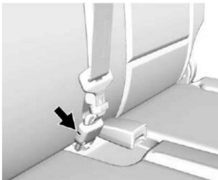
4. Desconecte el cerrojo pequeño del cinturón de seguridad trasero, utilizando una llave en la ranura del broche pequeño, y permita que el cinturón se retraiga en el techo interior.
