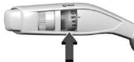
Los controles del limpiador/lavador de la ventana trasera se encuentran en el extremo de la palanca del limpiaparabrisas.
