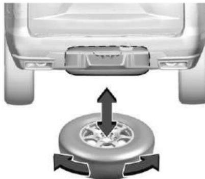
7. Cerciérese de que la llanta quede guardada de manera segura. Empuje, jale la llanta y después trate de girarla. Si la llanta se mueve, use la llave para las ruedas para apretar el cable.
