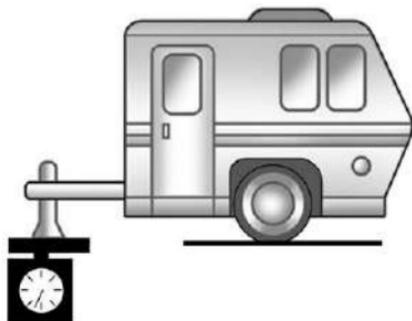
No exceda un peso máximo de la lengüeta del remolque de 567 kg (1,250 lbs) para un gancho de remolque convencional.
