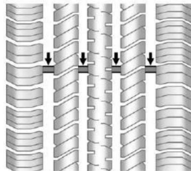
Los indicadores de desgaste del dibujo son una de las maneras de decidir cuándo es el momento para nuevas llantas. Los indicadores de desgaste aparecen cuando las llantas tienen solamente 1.6 mm (1/16 de pulgada) de dibujo remanente. Vea *Inspección de llantas* ⇨ 414 y *Rotación de la llanta* ⇨ 414.
