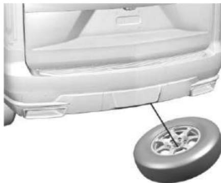
6. Incline la llanta de refacción hacia el vehículo dejando algo flojo el cable del elevador (11), para tener acceso al retenedor de la llanta/rueda (10).
