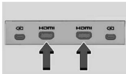
La entrada HDMI permite conectar un cable A/V HDMI desde un dispositivo auxiliar, como una videocámara, un sistema de videojuegos o un dispositivo Apple. Se requiere un cable de Apple para los dispositivos Apple.
