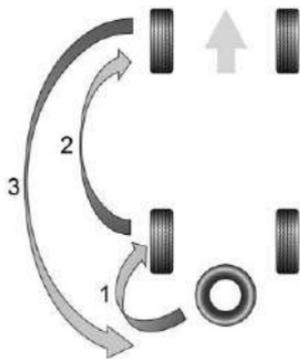
1. Retire la llanta trasera y reemplácela con la llanta de refacción realizando todos los pasos en Desinstalación de llanta ponchada e Instalación de llanta de refacción.
