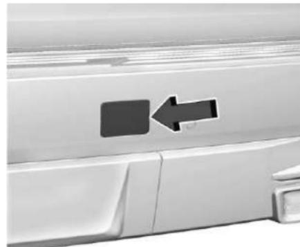
1. Abra la cubierta del seguro de la llanta de refacción en la defensa y use la llave mecánica para retirar el seguro de la llanta de refacción (6). Para retirar el seguro de la llanta de refacción inserte la llave mecánica, gírela, y jale en sentido recto hacia fuera.
