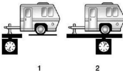
El peso de la lengüeta de remolque (1) debe ser 10–15% del peso total del remolque cargado (2). Algunos tipos de remolques específicos, como remolques de bote, están fuera de estos rangos. Siempre consulte el manual de propietario del remolque para el peso de lengüeta de remolque recomendado para cada remolque. Nunca exceda las cargas máximas para su vehículo, gancho y remolque.
