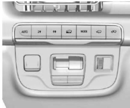
Para activar cada modo, presione el botón MODE en el tablero de instrumentos a la izquierda del volante. Para activar el modo Terreno, presione el botón
