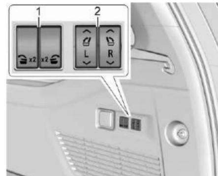
1. Interruptores de pliegue y abatimiento de asiento eléctrico de segunda fila (si está equipado)
