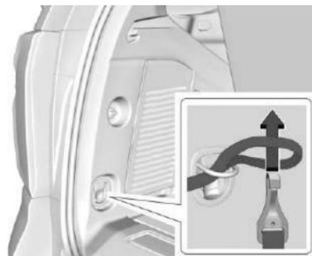
4. Retire la llanta pinchada, asegure la correa de la guantera y coloque el extremo del lazo de la correa a través del amarre de carga. Coloque el extremo del gancho de la correa a través del lazo y jálelo hasta que la correa esté asegurada firmemente al amarre.
