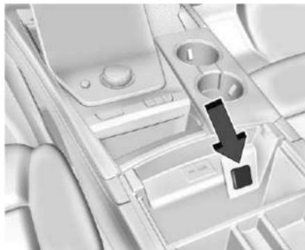
El vehículo tiene un tomacorriente para accesorios dentro de la consola central.
