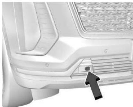
4. Conecte el cable del calentador en el conector en la defensa delantera.
