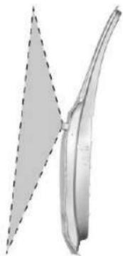
Si está equipado, una puerta se detendrá automáticamente si detecta un obstáculo en su camino durante un ciclo de apertura eléctrica. El sistema de puerta eléctrica no puede evitar una colisión que sea causado por un obstáculo hacia la puerta durante un ciclo de apertura eléctrica. Durante un ciclo de cierre eléctrico, la puerta sólo se detendrá si detecta resistencia pretendida. Los sensores pueden no detectar objetos que estén demasiado cerca (dentro de 10 pulg. (25 cm) del vehículo.
