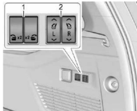
1. Interruptores de pliegue y abatimiento de asiento eléctrico de segunda fila
