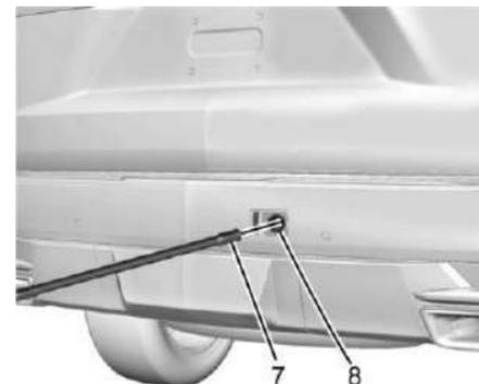
3. Inserte el extremo del elevador (extremo abierto) de la herramienta de extensión (7) a través del orificio de acceso al eje del elevador (8) en la defensa trasera hasta que sienta la conexión con el ensamble del elevador (1). Sólo será visible una cantidad mínima del extremo de extensión de la manija del gato.
