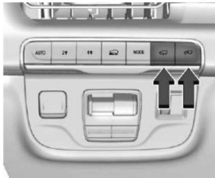
Presione el botón de Altura de conducción "Arriba" o "Abajo" para abrir el menú de Altura de conducción y seleccione la altura de conducción deseada. Después de una breve
