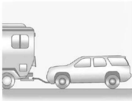
Sólo realice arrastres con remolque en vehículo con tracción en las cuatro ruedas que cuente con caja de transferencia de dos velocidades y que tengan configuración N (neutral) y 4 ↓.
