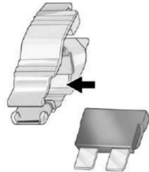
3. Use el extractor de fusible para retirar el fusible de la parte superior o lado, como se muestra anteriormente.
