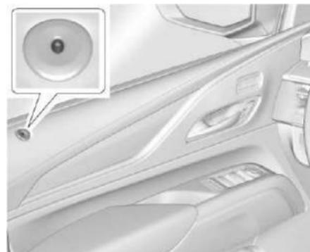
Una luz en la superficie superior de la moldura de la puerta del conductor se usa para indicar el estado de seguridad del vehículo.
