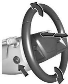
Para ajustar el volante de inclinación y telescópico eléctrico:
