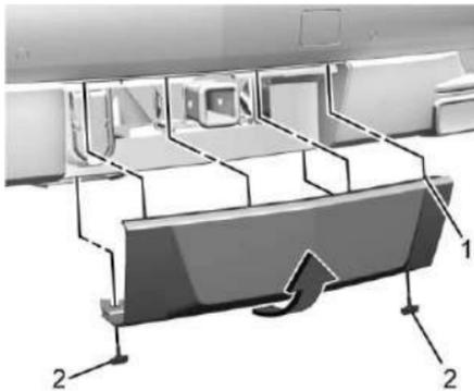
Para retirar la cubierta del gancho, si está equipada:
