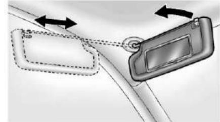
Tire de la visera hacia abajo para bloquear el resplandor. Desconecte la visera del montaje central para pivotarlo a la ventana lateral o, si está equipado, para extenderlo a lo largo de la varilla.
