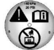
1. Retire el tapón de presión del tanque de compensación del refrigerante cuando el sistema de enfriamiento, incluyendo el tapón de presión del tanque de compensación del refrigerante y la manguera superior del radiador, ya no están calientes.
