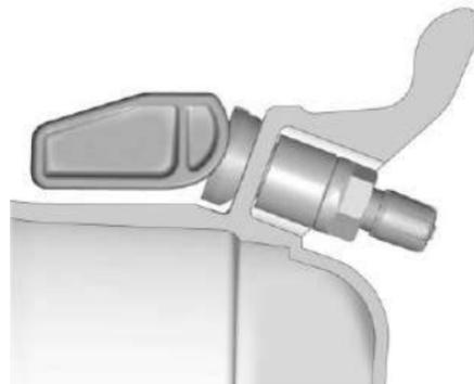
Póngase en contacto con el centro de servicio de su remolque o con el centro de servicio de llantas para instalar los sensores de presión dentro de las llantas del remolque. El técnico debe insertar el vástago del sensor a través del orificio en la rueda del remolque. Cuando el sensor está colocado correctamente, la tuerca en el vástago del sensor debe apretarse a 8N•m
