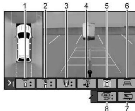
Toque los botones de vista de cámara en la parte inferior de la pantalla de infoentretenimiento para obtener acceso a cada vista (si está equipada):
