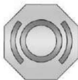
El depósito del cilindro maestro de frenos se llena con líquido de frenos DOT 4 aprobado por GM, como se indica en el tapón del depósito. Vea en *Vista general del compartimiento del motor* ⇨ 364 la ubicación del depósito.
