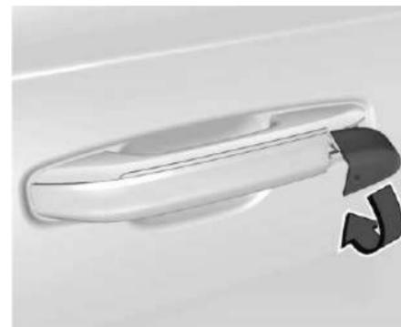
2. Gire hacia abajo para conectar la cubierta en posición.
