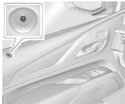
La luz indicadora, en la puerta del conductor cerca de la ventana, indica el estado del sistema. Vea *Seguros eléctricos de puertas* ⇨ 18
