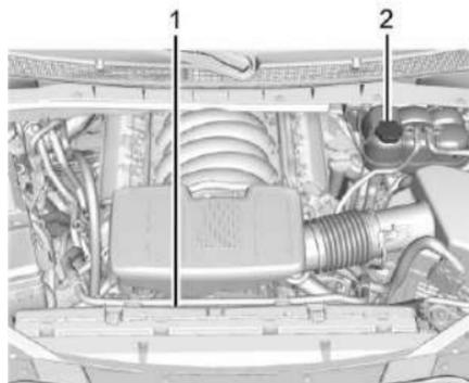
1. Ventiladores eléctricos de enfriamiento del motor (no visibles)
