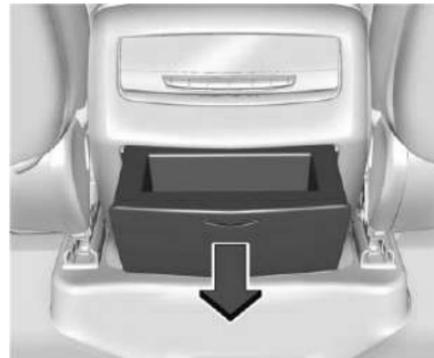
Si está equipado con almacenamiento en la consola central trasera, presione la cubierta y libere para tener acceso. Pueden haber dos puertos USB, dos puertos HDMI, y un tomacorriente en la parte trasera de la consola central.
