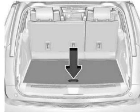
Hay almacenamiento en el piso del área de carga trasera. Levante la palanca para acceder.
