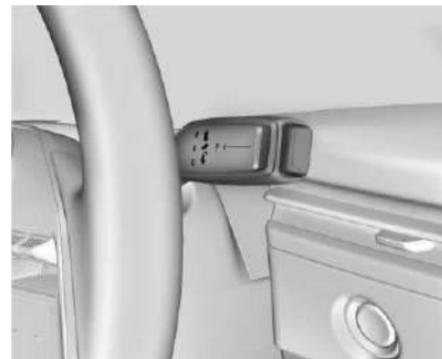
El patrón de cambios se muestra en la parte delantera de la palanca de cambios. La posición de velocidad seleccionada se iluminará en rojo en la palanca de cambios, mientras que todas las demás se proyectarán en blanco. Si el
