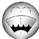
Abra el tapón que tiene el símbolo del lavaparabrisas. Agregue líquido para lavaparabrisas hasta llenar el tanque. Vea en *Vista general del compartimiento del motor* ⇨ 364 la ubicación del depósito.
